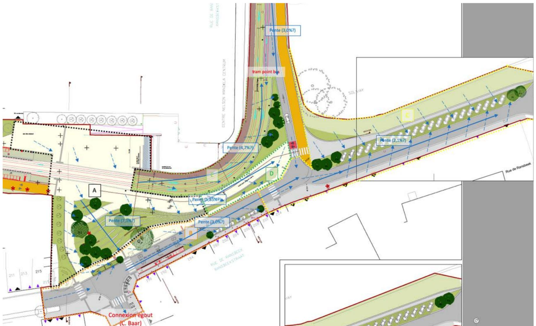
Figure 205 : Principe de Gestion Intégrée des Eaux Pluviales - Chemin Vert - Stade
