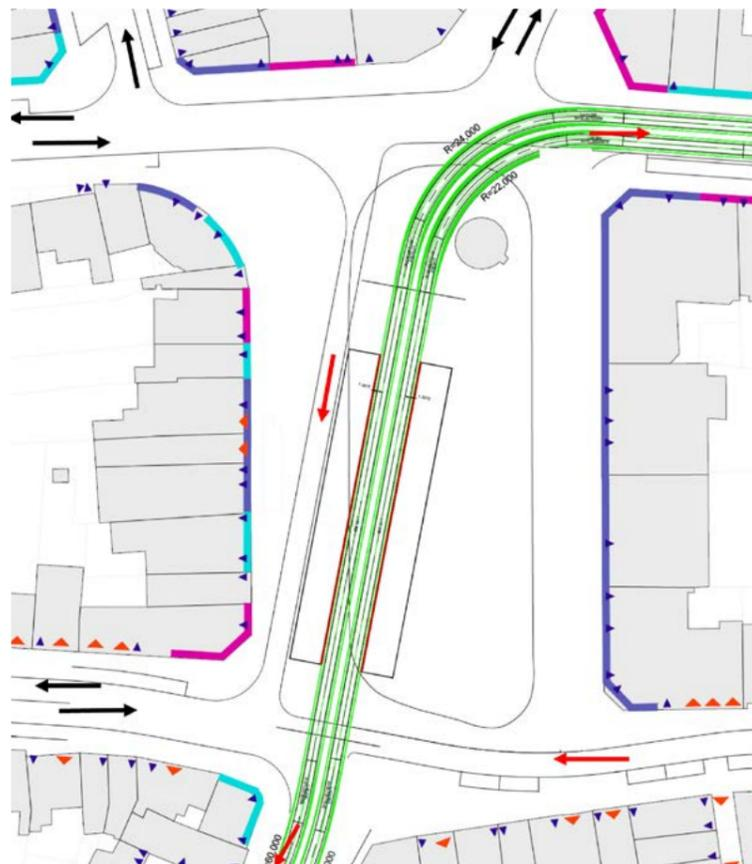
Figure 38 : Zavelput - Schéma d'implantation des voies de tram
