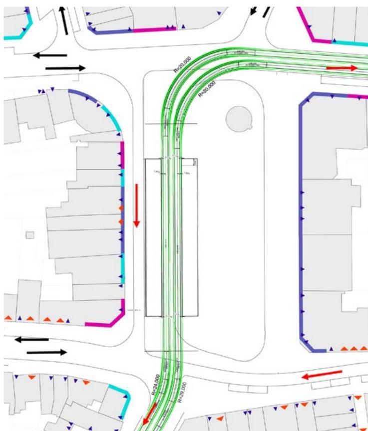
Figure 37 : Zavelput - Schéma d'implantation des voies de tram
