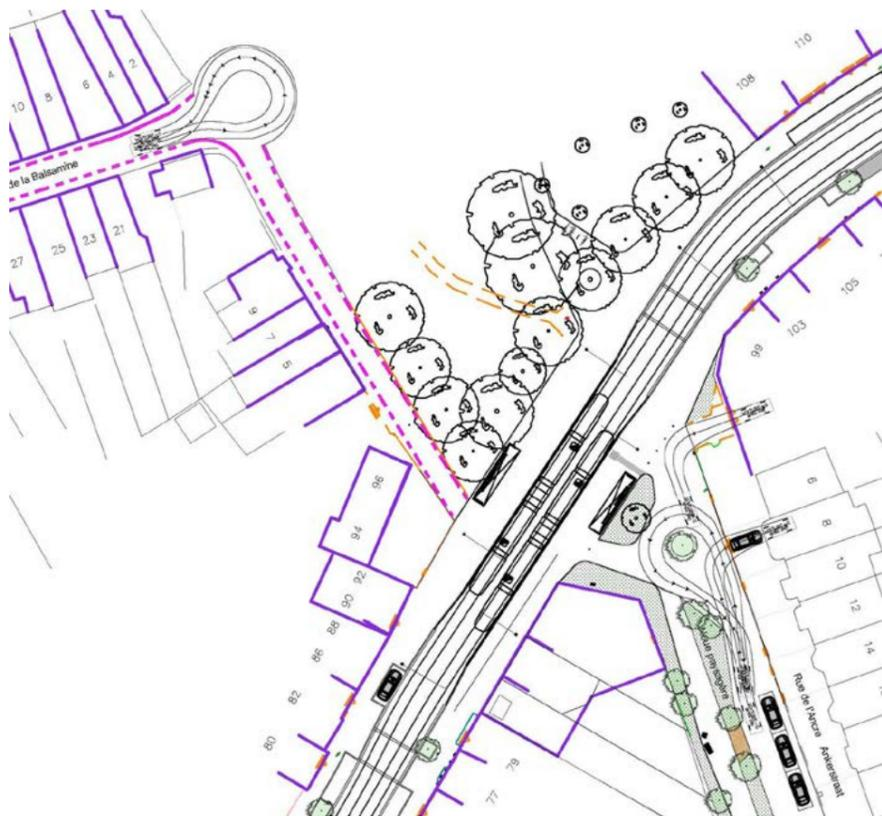
Figure 63 : principes des zones de demi-tour dans Ancre et Balsamine
